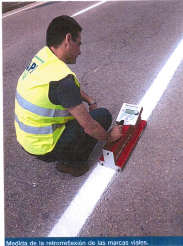
Medida de la retroreflexión de las marcas viales.
